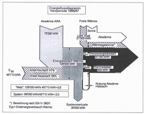
Bild 5. Aussagekräftiges Energieflussdiagramm
