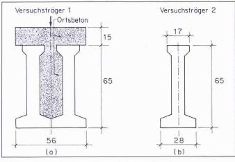
Bild 4. Querschnitt der Versuchsträger (1944)
