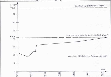
Bild 8. Zeitliche Entwicklung der Dehnungen in Brückenmitte
