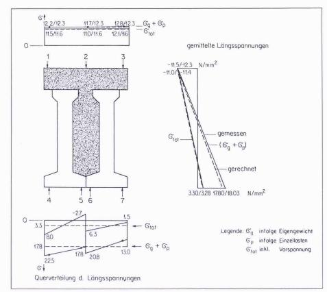
Bild 6. Gemessene und berechnete Spannungen am Versuchsträger 1
