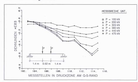
Bild 12. Statischer Versuch am Balken 1 (Febr./März 1984)
