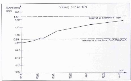
Bild 7. Zeitliche Entwicklung der Durchbiegung in Brückenmitte
