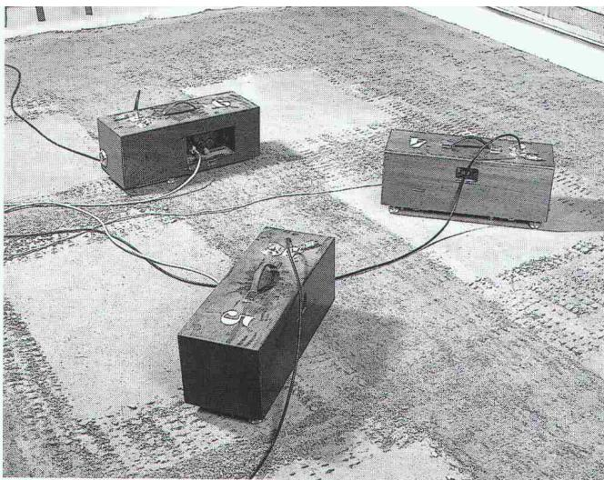
Trittschallprüfung mit Klopfgeräten unter realen Baubedingungen (Unterlagsboden vollflächig, lange Belastungsdauer) in der EMPA Zürich.
