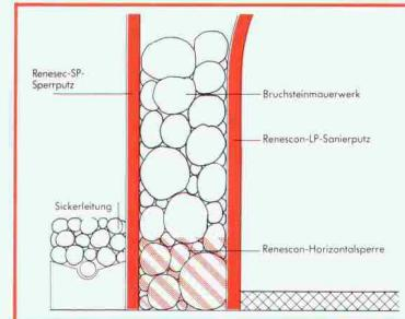
Die Renescon-Horizontalsperre verhindert das Aufsteigen der Feuchtigkeit. Das Mauerwerk trocknet aus.
