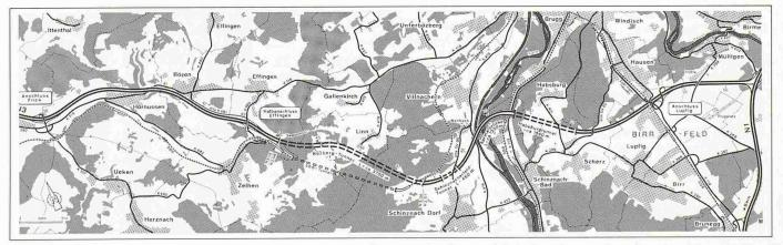
Der 3,7 km lange Bözbergtunnel ist das Kernstück des zukünftigen, 19 km langen N3-Teilstücks zwischen dem Anschluss Frick und der Verzweigung Birrfeld. Zu den weiteren grösseren Bauwerken gehören der 1540 m lange Habsburgtunnel, der 450 m lange Schinznacherfeld-Tunnel und die Zwillingsbrücke über das Aaretal
