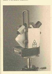
Mit einem Handgriff kann der Theoplane in einen Rotationslaser verwandelt werden, indem der Rotationskopf aufgesetzt wird. Damit erzeugt er eine Laserebene in horizontaler, vertikaler oder beliebig geneigter Lage.
