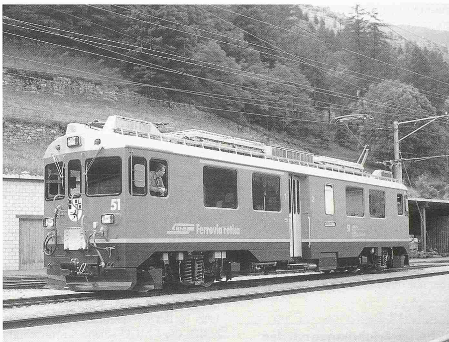
Bild 3. Neuer Umrichter-Triebwagen ABe 4/4 51 in Poschiavo
