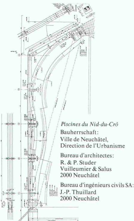
Die markante kubische Beton-Marmor-Glas-Struktur der grosszügigen Frei- und Hallenbadanlage an den neugestalteten Gestaden des Neuenburgersees trägt an 4 Pylonmasten das elegante und neuartige Wellentragwerk in Brettschichtholzbauweise.
