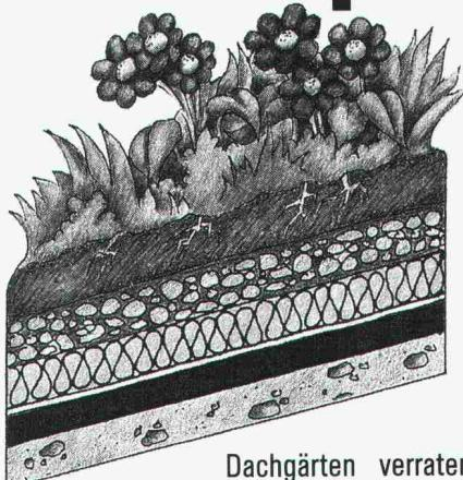
Dachgärten verraten nicht, wie es «darunter» aussieht. Erst ein Schnitt gibt Einblick in den Dachaufbau und lässt seine Stärken und Schwächen erkennen. Gussasphalt - ein natürlicher und umweltgerechter Baustoff - zeichnet sich durch seine robuste Einbaustärke aus, die am besten Dichtigkeit und Wurzelschutz garantiert. Verlangen Sie unsere Dokumentation über Dachgärten.
