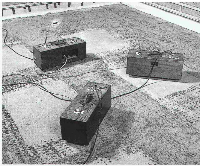
Trittschallprüfung mit Klopfgeräten unter realen Baubedingungen (Unterlagsboden vollflächig, lange Belastungsdauer) in der EMPA Zürich.
