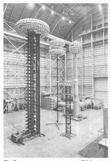
Ein Stossspannungsgenerator (Bilder: aus der Festschrift «100 Jahre SEV»)
