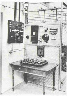
Prüfeinrichtungen gestern und heute: Glühlampendauerprüfung um 1906
