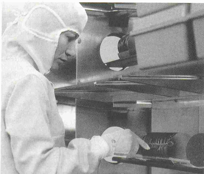
Fertige integrierte Schaltungen auf einem «Waver» vor dem Zersägen in die einzelnen Siliziumplättchen
