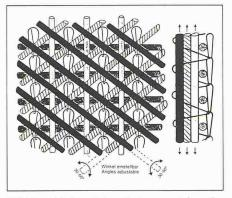
Bild 1. Multiaxiales Kettengewirke, das als Flächengebilde diagonal auftretende Kräfte aufnehmen kann und einen hohen Widerstand gegen Ein- und Weiterreissen besitzt (H. Mewes, Bobingen)
