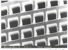
Ausschnittvergrösserung aus der Stirnfläche eines mechanisch hergestellten Mikrostrukturkörpers, der von etwa 10 000 Mikrokanälen pro cm² durchzogen ist
