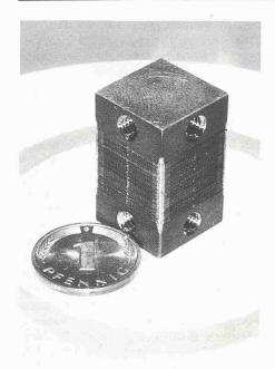
Aufnahme eines aus mechanisch strukturierten Folien hergestellten Mikrowärmetauschers mit extrem hohem Wärmedurchgangskoeffizienten. Im Volumen von 1 cm³ sind pro Seite rund 4000 Strömungskanäle untergebracht. Die gesamte Übertragungsfläche liegt bei 150 cm²
