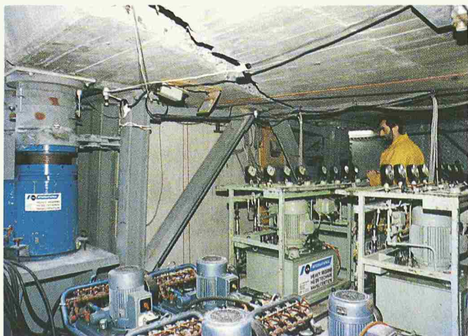
Bild 9. Hydraulikaggregate und horizontale Pressenfixierung (L. Buscarlet)
