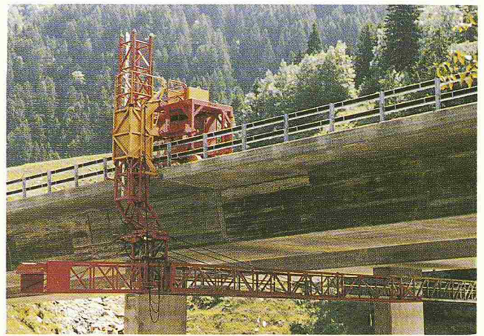
Bild 3. Untersichtsgerät «Moog» Typ MBS 200 im Einsatz Bildautor: A. von Glutz
