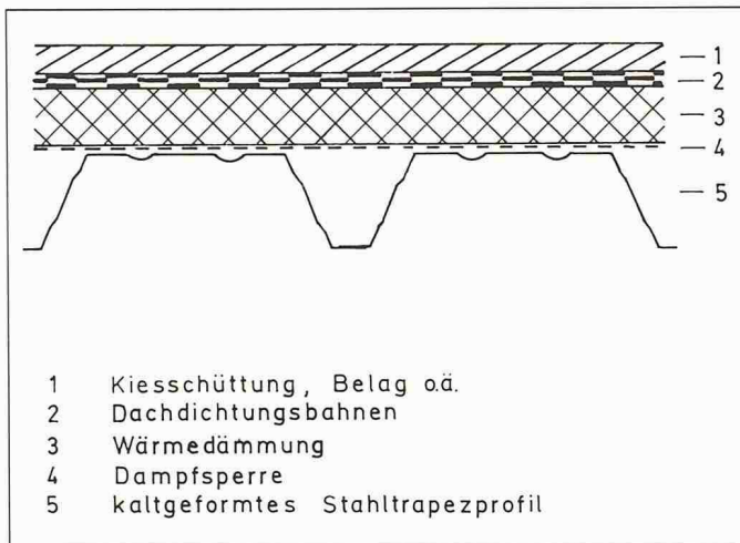
Bild 1. Typischer Aufbau eines Warmdaches
