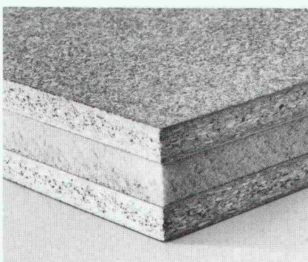
HOMISOL DUO Elemente bestehen aus zwei formaldehydfrei gebundenen Spanplatten und einer druckfesten Kernisolation aus Polyurethan. Sie sind tauchgrundfest hergestellt und lassen sich beliebig beschichten, furnieren oder streichen. Die steglose Verbindung garantiert einen durchgehend gleichmässigen  $k$ -Wert. Verlangen Sie ausführliche Unterlagen über Elemente und Befestigungstechnik. Rufen Sie uns an.
