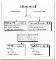
Bild 4. Versuchsablauf zur Standardund Werkbeton- sowie Zementprüfung
