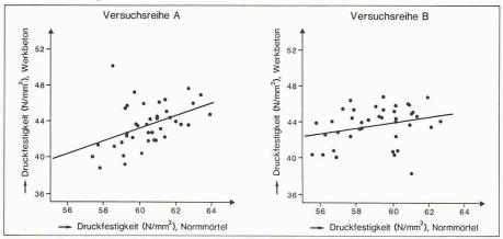
Bild 7. Korrelation der Druckfestigkeiten Normmörtel-Werkbeton
