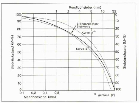
Bild 1. Siebkurve der Zuschlagstoffe des Standardbetons
