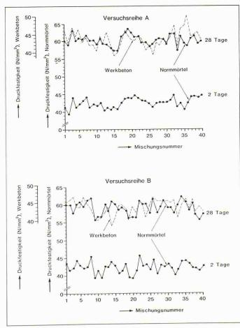
Bild 5. Vergleichende Gegenüberstellung: Druckfestigkeit Normmörtel-Werkbeton
