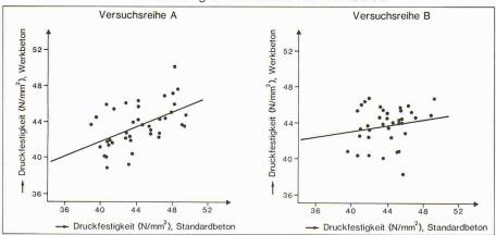
Bild 8. Korrelation der Druckfestigkeiten Standardbeton-Werkbeton
