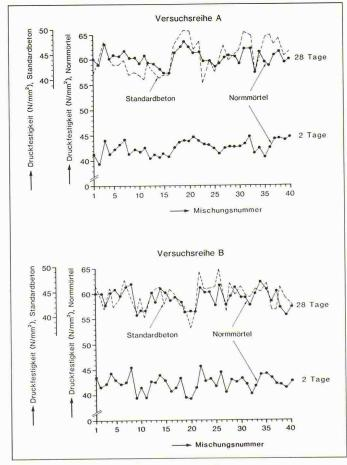
Bild 6. Vergleichende Gegenüberstellung: Druckfestigkeit Normmörtel-Standardbeton
