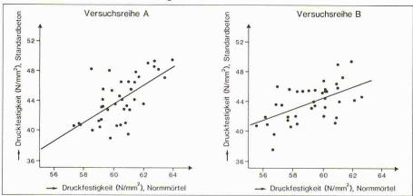
Bild 9. Korrelation der Druckfestigkeiten Normmörtel-Standardbeton
