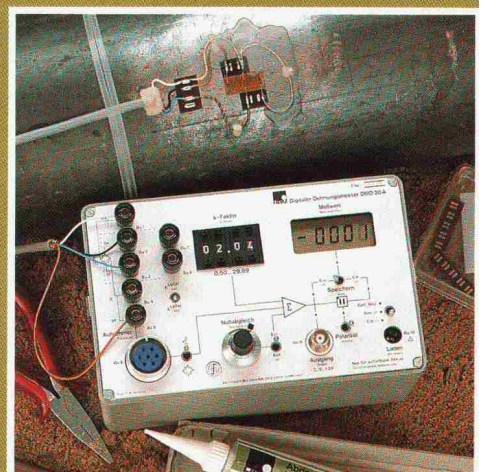
Experimentelle Spannungsanalyse vor Ort mit Dehnungsmessstreifen und mobilen Geräten
