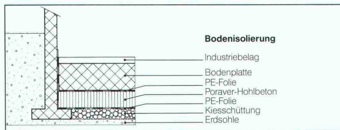
Die ultraleichten Glasschaumkugeln garantieren eine hohe thermische Dämmung. Sie sind formstabil, unbrennbar und biologisch hochwertig.
