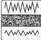
**Resobloc®** ist ein neu entwickeltes Akustiklager von Kilcher. Es besteht aus Neugummigranulat, welches mit Polyurethan gebunden ist. Eine spezielle Folie an der Oberfläche verhindert ein Aufsteigen von Feuchtigkeit. Einsatz im Neubau unter tragenden und nichttragenden Wänden.
