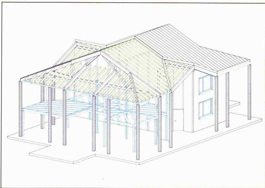
Bild 1. Täuffeln: Axonometrie einer Holzkonstruktion. Architekten: Schär, Port und Sommer; Ingenieure: Bois-Consult Natterer SA, Etoy
