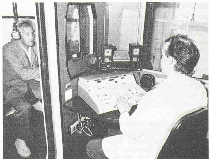
Aufnahme der Hörkurve mit dem Audiometer im Audiomobil der SUVA
