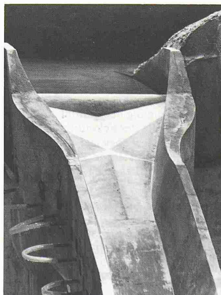
Bild 12. Modell eines düsenförmigen Einlaufs zu einer Schussrinne. Stossdämpfende Kontraktion der Strömung durch Verwindung der Sohle. Approximation der gekrümmten Fläche durch mehrere Ebenen (Foto VAW)
