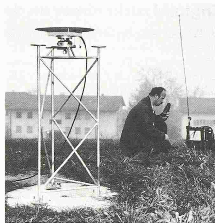
Mit Hilfe einer neuen, satellitenunterstützten Vermessungsmethode wurde die Position von 24 Kontrollpunkten in der Nordschweiz millimetergenau bestimmt. Die Antenne steht genau über einem einbetonierten Vermessungspunkt. Die empfangenen Signale, die von Satelliten ausgesandt werden, werden über ein Antennenkabel an ein transportables Empfangsgerät weitergeleitet
