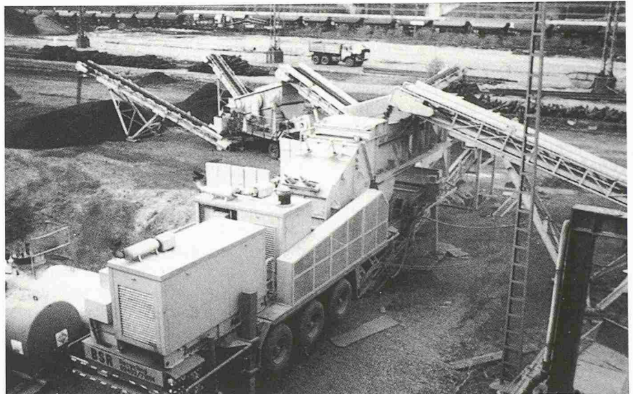
Eine mobile Bauschutt-Recyclinganlage wird in Köln eingesetzt, um den ehemaligen Eilgutbahnhof Gereon altlastenfrei abzubauen. Käufer des 200 000 m grossen Areals ist die Stadt Köln (Bild: dbp)
