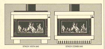
Besonders geschätzt wird u.a. die totale Kontrolle über die Verbrennung, so dass ein loderndes Feuer für das schnelle Aufheizen kalter Räume in wenigen Sekunden in einen Dauerbrand umgewandelt werden kann (bis zu 10 Stunden mit einer Ladung Hartholz).
