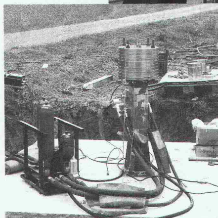
Schwingungserregung einer Fundamentplatte.
