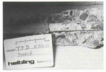
Bild 11. Anode von Versuch 6 mit 20 bis 40 mA/m<sup>2</sup> Schutzstromdichte. Die geringe Ph-Absenkung um die Anode konnte durch die Farbreaktion des Indikators nachgewiesen werden
