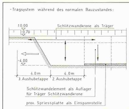
Nachdem im Eintagesrhythmus alle Etappen dieser Phase ausgehoben waren, die provisorische Spriessplatte über die ganze Grundfläche erstellt wurde, entstand als Resultat eine offene Baugrube im Bereich des ersten Untergeschosses. Die äusserst schlanke Spriessplatte von zwanzig Zentimeter Stärke, von Schlitzwand zu Schlitzwand über zweiundzwanzig Meter wirkend, war knickgefährdet. Die Stabilität dieser Platte wurde überprüft und ergab eine ausreichende Sicherheit.
