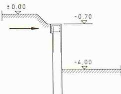
Auf der Nordseite der Baustelle wurde nun eine erste Etappe von fünf Meter über die ganze Baugrubenbreite ausgehoben. Abschluss der Aushubetappe bildete eine Böschung von sechzig Grad Neigung. Die Schlitzwandkrone wirkte nun als Auflager für die Wandelemente
