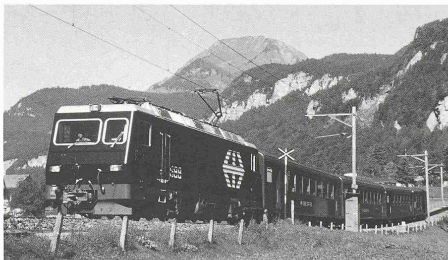
Brünigbahn-Zug mit neuer Zahnradlokomotive HGe 4/4 II
