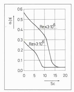
Bild 2. Verhältnis Kaminspitzenausbiegung zu Durchmesser in Funktion der Scruton-Kennzahl mit der Reynolds-Kennzahl als Parameter
