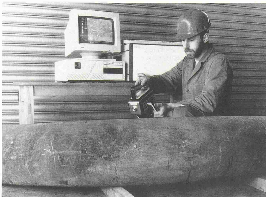
Wärmemikroskop, hier im Einsatz an einer Rohrbiegung im konventionellen Kraftwerksbau. Der Computer macht die Materialeigenschaften sichtbar
