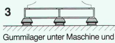
Gummilager unter Maschine und Rahmen
