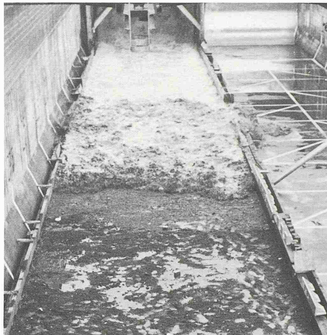
Bild 9. Spülvorgang mit Spülkasten in Natur bei derselben Verschmutzung. Der aufwühlenden Frontwalze folgt eine Nachlaufströmung, die zusätzlich Schmutzstoffe mitreisst
