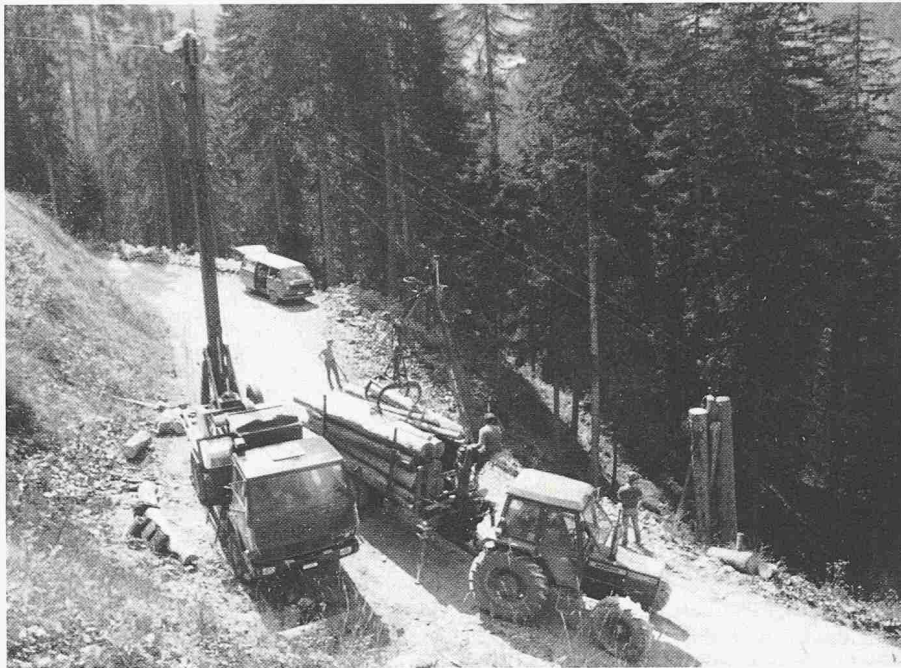
Bild 3. Der Mobilseilkran K-600 Sanasilva beim Bergauftransport von Trümmern aus einer Zwangsnutzung im Gebirgswald
