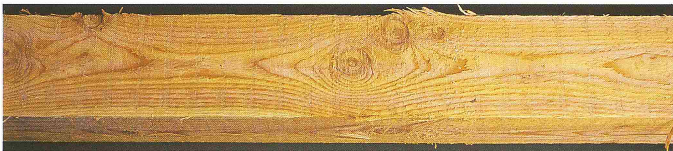
Bilder 2a, 2b, 2c. Störung des Faserverlaufs bzw. der Holzstruktur durch Äste. Die Aststörzone kann um ein Vielfaches grösser sein als der eigentliche Ast.
