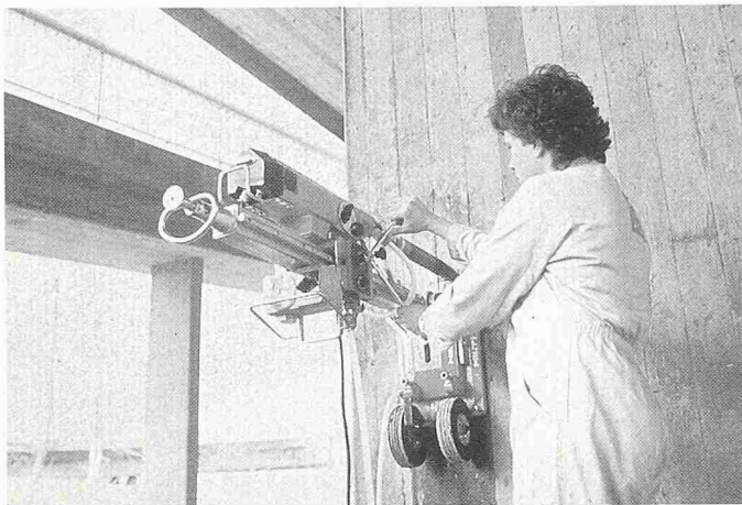
Bild 3. Probeentnahme für Chloridbestimmung mittels Diamantbohrung (Werkphoto SIKA AG)
