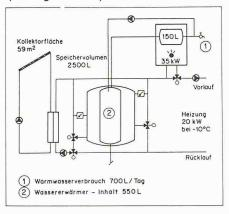
Bild 6. Anlage Haus 24 mit Pufferspeicher
