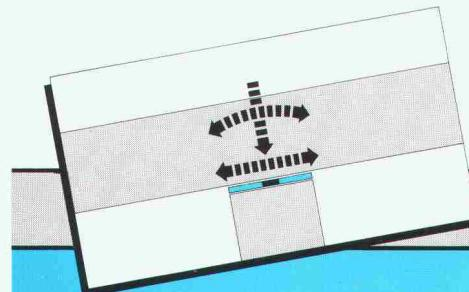
Gleit- und Deformationslager mit den Funktionen Lastaufnahme, Rotation und horizontales Gleiten
