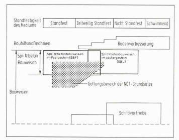
Bild 1. Relation der NOT zu den Spritzbetonbauweisen
