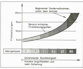
Bild 2. Grössenordnung kritischer Setzungen, die in Tunneln mit Spannweiten von mehr als 10 m zu Verbrüchen führen können
