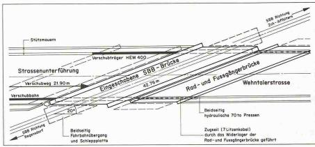
Bild 2. Grundriss Unterführung Wehntalerstrasse
