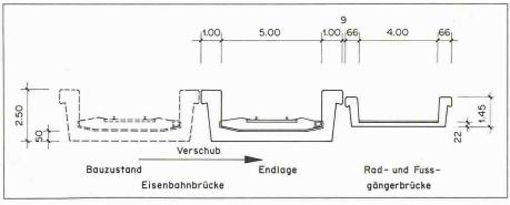
Bild 5. Querschnitt senkrecht zur Brückenaxe
