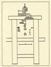
Bild 2. Kartesischer Roboter ARIA für die Mikrotechnik, «FAL»-Ausführung (Flexible Automation Line)
