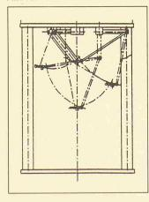
sche Achse mit einem Hub von 25 mm. Im Arbeitvolumen von 300 mm Durchmesser und 200 mm Höhe werden Operationen mit einer Geschwindigkeit von 4 m/s, einer Beschleunigung von 40 m/s, einer Auflösung von 0,02 mm und der Genauigkeit von +/- 0,05 mm ausgeführt.
