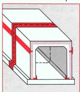
Die 1800 m lange, neue SZU-Strecke (Sihltalbahn) im Bett der Sihl kommt unter den Wasserspiegel zu liegen. Für Betriebssicherheit und Schutz des Bauwerks sind zuverlässige Abdichtungen nötig.
