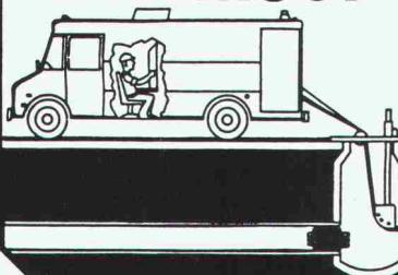
Optische und pneumatische Prüfung von Rohrleitungen. Dichten von Muffen, Rissen und Wurzeleinwachsen, ohne zu graben.
