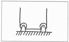
Bild 2. Untere Rückführung des Seils
