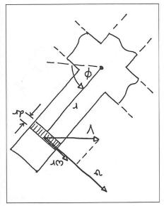
Bild 2. Luftkräfte am Flügelelement
