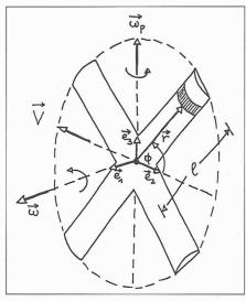
Bild 1. Schematische Darstellung des Kreuzbumerangs
