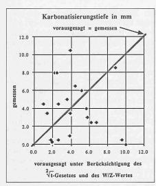
Bild 1. Vergleich zwischen gemessenen und gerechneten Karbonatisierungstiefen
