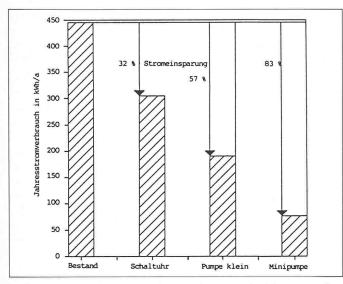
Elektrizitätseinsparungen bei Umwälzpumpen: durch bessere Regelung (Schaltuhr), oder richtig dimensionierte Pumpen (Pumpe klein) oder richtig geregelte und dimensionierte und moderne Pumpen (Minipumpen) am Beispiel eines
