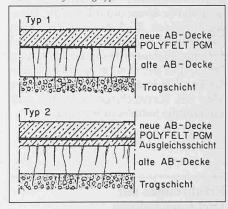
Bild 4. Einstreudecke bei der Asphaltstrassensa-
