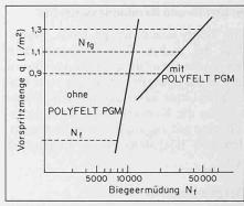
Bild 1. Versuchsergebnisse zur Bestimmung des Geotextilwirkungsgrades FEF von Polyfelt PGM 14 als f (Biegeermüdung  $N_f$ , Vorspritzmenge q).
