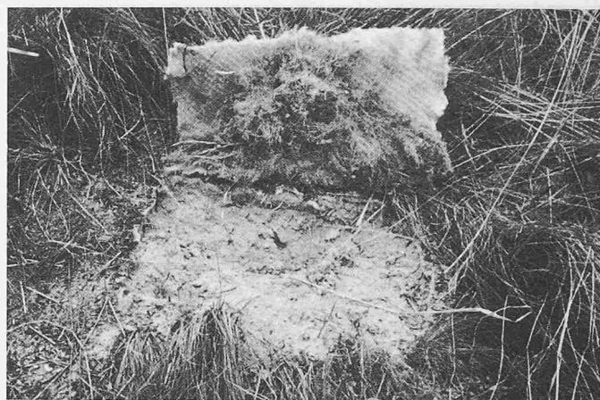
Bild 13. Grasdurchwurzeltes Standard-Vlies, Porenweite etwa 0,08 mm, Dicke etwa 2 mm
